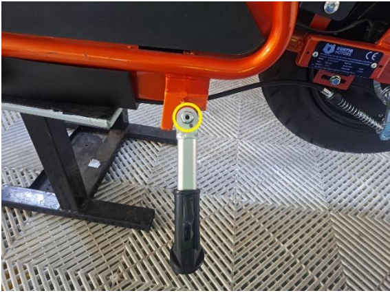
Irrota sivujalan kiinnityspultti (kiintoavain 14 mm).
